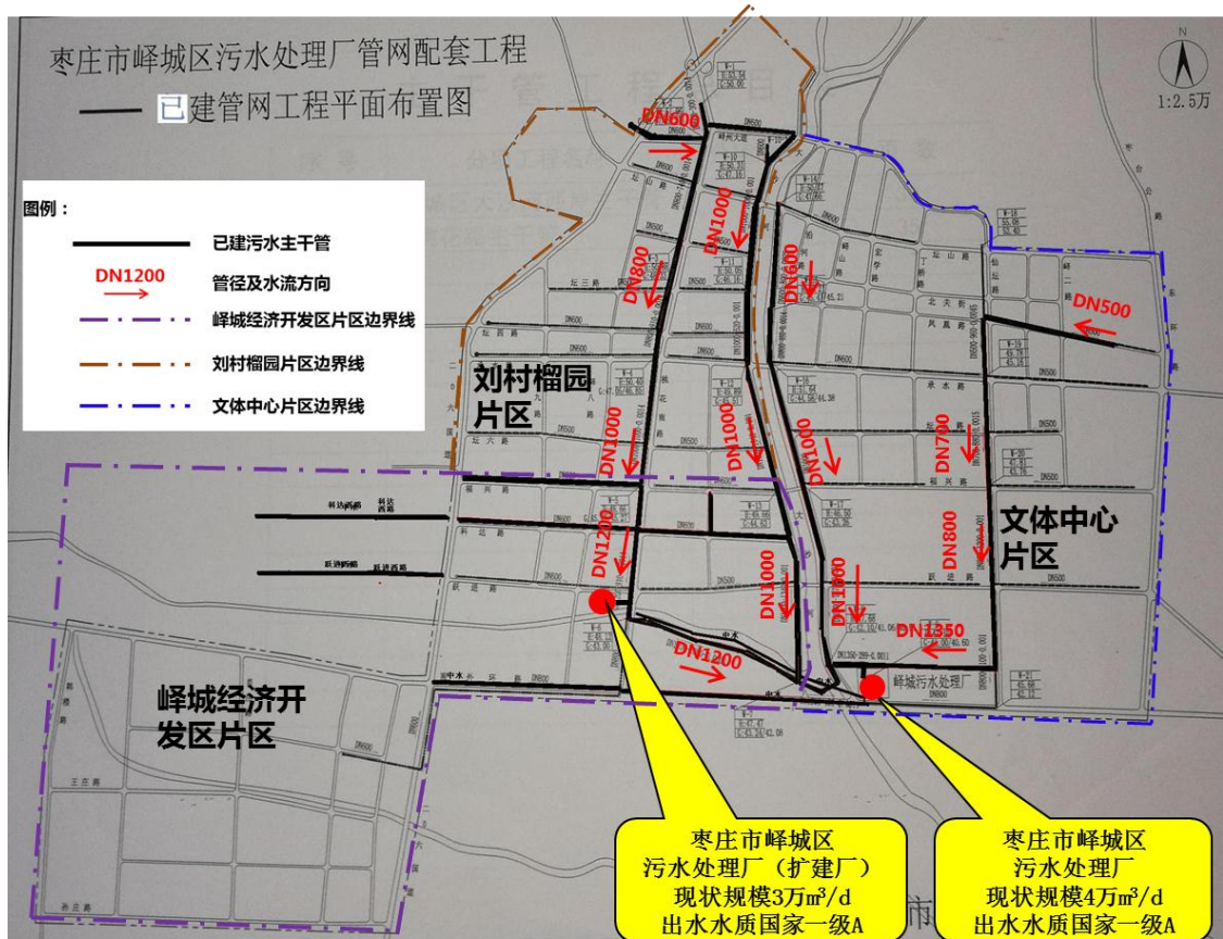
枣庄市峰城区现状污水管网平面布置图 图 2.4-2
