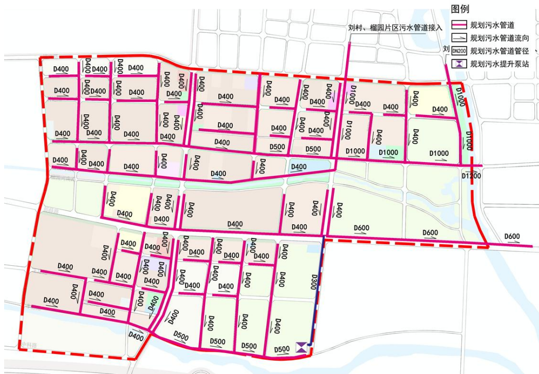
枣庄市峰城区经济开发区片区规划污水管网平面布置图 图 2.4-6
