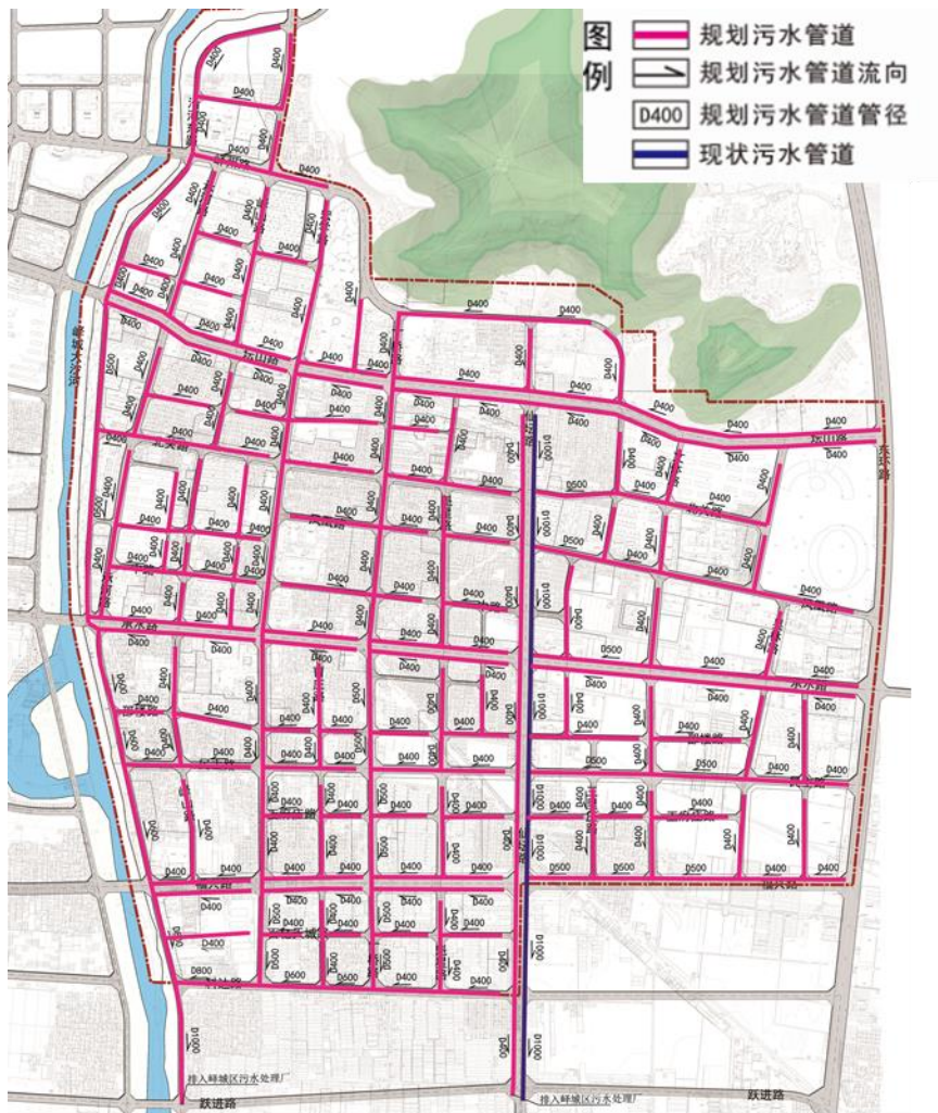
图 2.4-5 枣庄市峰城区文体中心片区规划污水管网平面布置图
