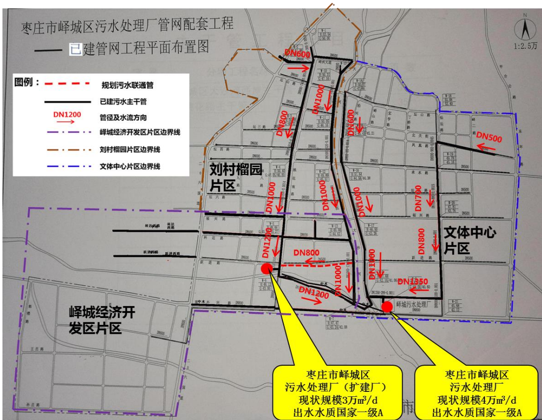
枣庄市峰城区规划污水联通管路由示意图 图 2.4-3
