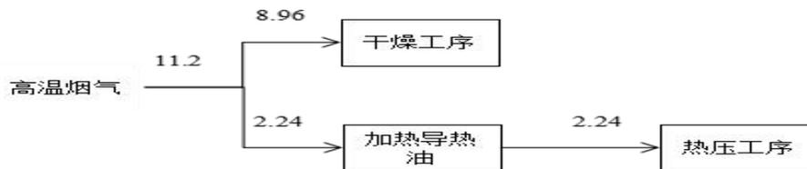
图 2-4 热能中心热量平衡图
