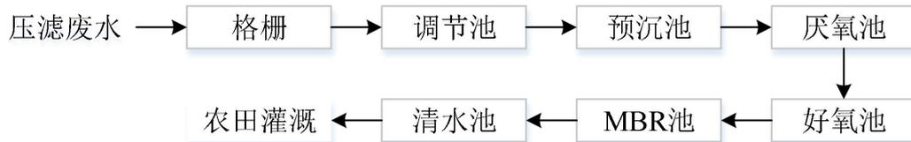
图 2-5 废水处理工艺流程图
