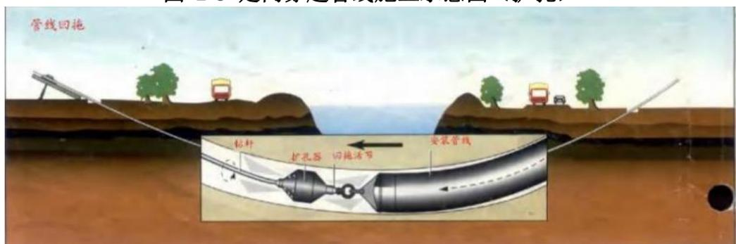
图 2-9 定向穿越管线施工示意图 (回拖管线)
