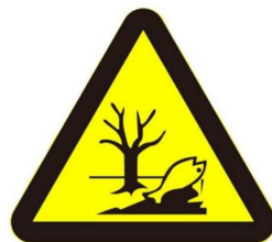
危险废物贮存间标识
